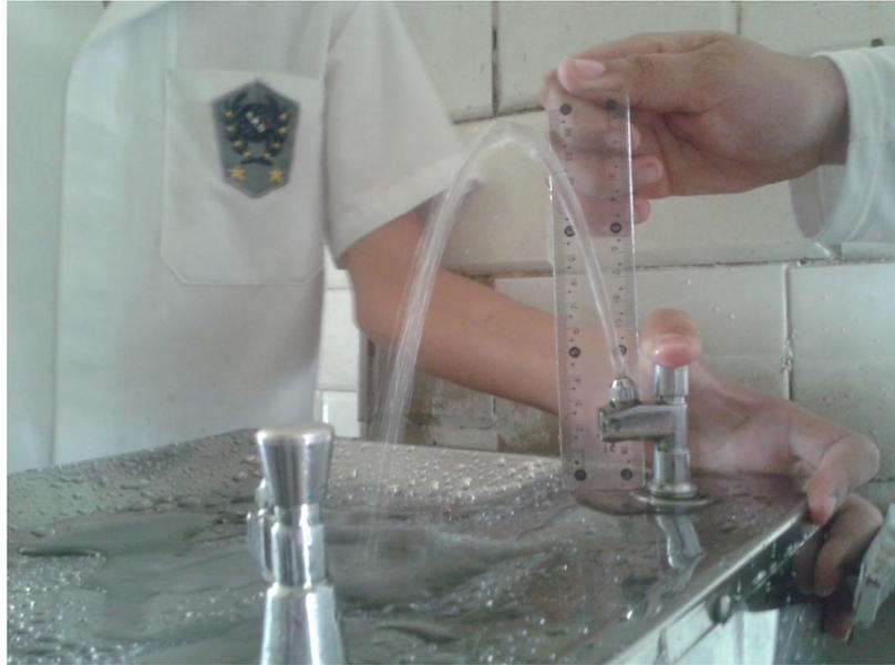
Além disso, foi medida *in loco* a altura do jato, ou seja, o ponto onde o jato possui velocidade vertical igual a 0, o vértice da parábola. A medida encontrada foi de 15 cm, A PARTIR DA SUPERFÍCIE DA BANDEJA. Vale ressaltar que devemos subtrair desse comprimento altura do bico lançador de água, que foi aferida em 4,5 cm. Desta forma, a medida a ser utilizada nos cálculos, como já explicado no roteiro, é de 10,5 cm. Convertendo em metros, temos 0,105m.
