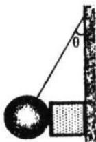
Sendo  $\mu$  o coeficiente de atrito estático entre todas as superfícies em contato e sabendo-se que a massa pendular é igual à do bloco, pede-se calcular o ângulo  $\theta$ .
