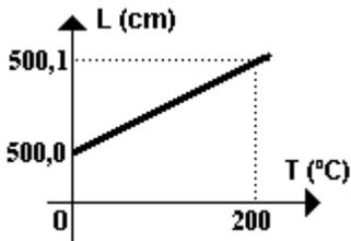
20. O gráfico ao lado nos mostra como varia o comprimento de uma barra metálica em função da sua temperatura. Uma panela feita com o mesmo material da barra tem uma capacidade de 1000 ml, a 0°C. Calcule a capacidade desta panela a 100°C.
